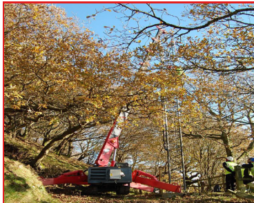
Gefälleausgleich durch Abstützung möglich
